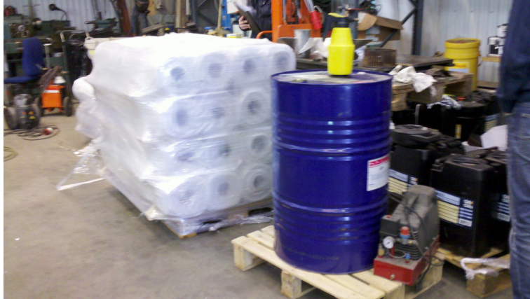
Fig. 5. Oskyddad förvaring av miljöfarliga vätskor i närheten av en golvbrunn inomhus. Foto: Ann Nystad
